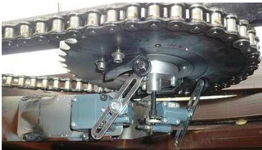
Figura 6.6.1 Installazione dei finecorsa per i due sensi di marcia
