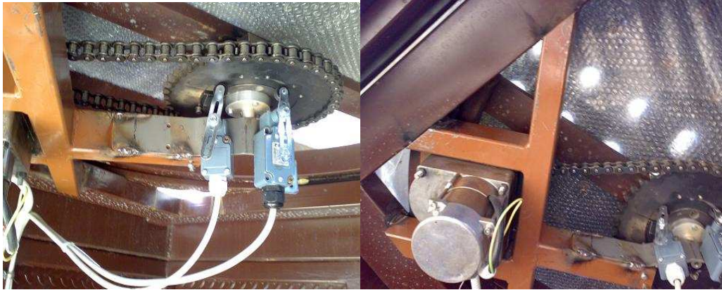
Figura : 5.6.6. collegamento dei finecorsa e del motore al motoriduttore
