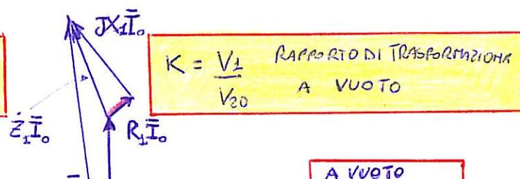
$$K = \frac{V_1}{V_{20}} \quad \text{RAPPORTO DI TRASFORMAZIONA A VUOTO}$$
