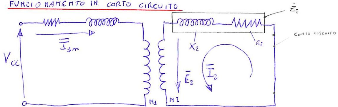
Nel funzionamento in corto circuito l'impedenza del carico esterno al secondario risulta nulla, quindi  $\dot{z}_2 = 0$  ne consegue  $\bar{V}_2 = 0$
