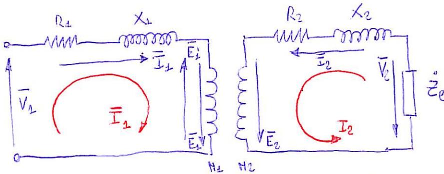
Si analizzano le due maglie del circuito primario e secondario.
