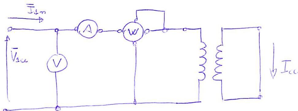
Essendo il secondario chiuso in corto circuito si alimenta il primario all'opportuna tensione  $\bar{V}_{1cc}$  che fa circolare in esso la  $\bar{I}_{1m}$ . Quindi il trasformatore può funzionare in queste condizioni anche indefinitamente.
