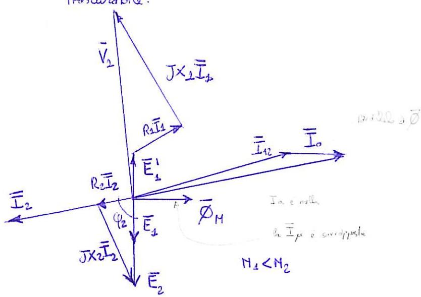
Definiamo la tensione di corto circuito  $V_{cc}$  come la tensione rispetto all'induttanza magnetica per centovolt. Secondo la quale circolano nel primario e nel secondario le correnti nominali  $I_{1n}$  e  $I_{2n}$ .
