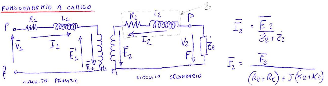
Per lo studio del trasformatore monofase a carico si sviluppa analizzando il circuito secondario. Consideriamo la corrente  $I_2$ , essa da origine alla forza magnetica matrice  $\bar{M}_2$
