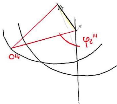
Si dimostra con la trigonometria applicata ai vari segmenti del diagr. di Kapp. che vale la seguente relazione per le cadute di tensione  $\Delta V_{12}$  tra vuoto e carico. (vedi pag 23 MORINI)
