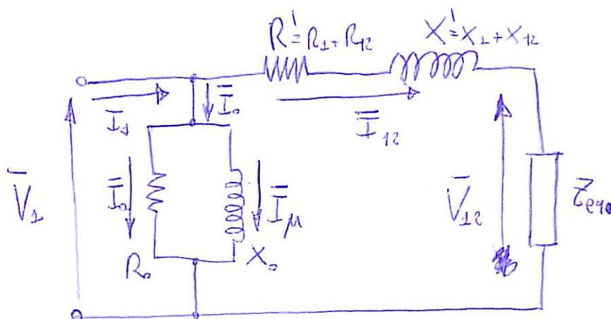
E' possibile trascurare  $\bar{I}_o$  nel modello quando questo risulta molto più piccolo di  $\bar{I}_{12}$  e  $\bar{V}_{12}$  (ma comunque presente perché serve la componente magnetizzante).
