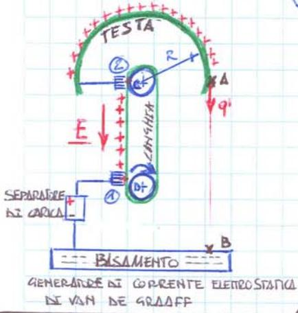
Abbiamo un nastro isolante fuso tra due ruote C e D, che D è posto in rotazione da un motore; durante il giro il nastro passa vicino ad un pettine ① il quale ha un eccesso di carica grazie ad un generatore (separatore di carica) che dà carica ( $+q$ )
