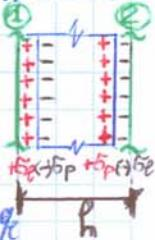
Per qualsiasi reazione interna sull'isolante ha equilibrio  $E = E_o + E_p = 0$ , ma nel condensatore con il suo interno l'isolante so esistere un campo elettrico  $E_k$ , calcolabile qui come somma degli effetti  $E_o$
