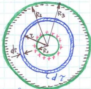
Ora se il volume  $V$  varia da  $R_1$  a  $\infty$  otengo in definitiva l'energia potenziale elettrostatica del conduttore  $C_1$  posto nello spazio isolato
