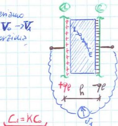
Il fenomeno osservato, e materialmente espresso a livello macroscopico dalle relazioni  $C_d = K \cdot C_0$  (perché  $C_0 = 1$ ) è portatore di un significato ben più profondo perché legato alla struttura microscopica elettrica della matrice, vediamo i dettagli.
