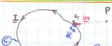
Possiamo applicare da la I<sup>o</sup> legge elementare di LAPLACE a delle configurazioni semplici, in cui la corrente percorre un conduttore filiforme, cercando di ridurre l'integrale calcolato sul circuito  $C$  ad un integrale monachimensionale.
