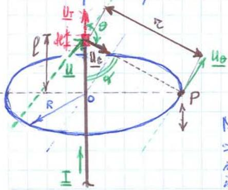
Per il generico punto  $P$  posto a distanza  $z$  dall'elemento infinitesimo  $dl$  del circuito, il campo magnetico a cui è soggetto si misura con la 1<sup>a</sup> legge elementare di LAPLACE
