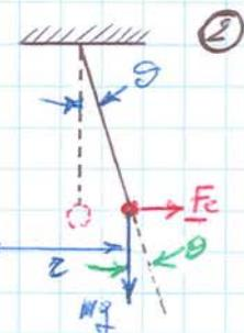
Si vuole calcolare l'angolo  $\theta$  che viene a formarsi con lo asticella per effetto dello spostamento della carica  $q$
