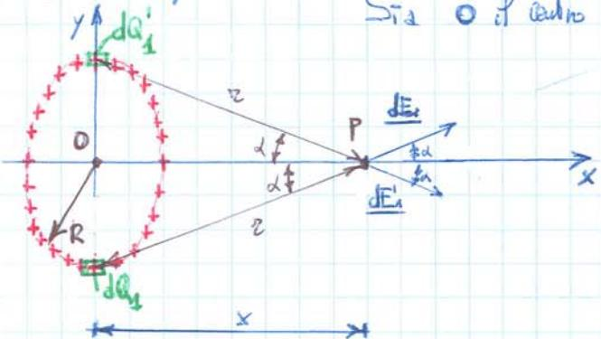
Presto ora un generico punto  $P$  lungo l'asse  $x$  distanza  $x$  dal centro  $O$  dell'anello. L'elemento infinitesimo di carica  $dQ$ , nel CASO ELETROSTATICO (cioè  $V_0 = 0$ ) produce un campo elettrico  $dE$  di intensità
