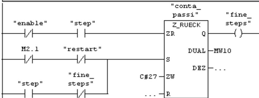
Il segmento 2 è qui mostrato solo per mettere in evidenza che il contatore funziona selezionando direttamente i secondi in cui si verifica l'evento e non è necessari la moltiplicazione per 10 come nel caso del timer del ciclo automatico.
