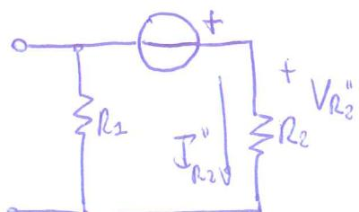
$$I_{R_2''} = \frac{(E_R2 \text{ dalla eq. n. maglia})}{R_2 + R_1} = 1,2A$$
