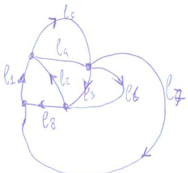
Possiamo orientare i lati con delle frecce coerenti con le correnti o meglio: riferimenti posti per le correnti ottenendo un grafo orientato.
