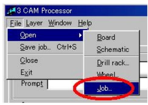
Che si trova nel file “pcb-proto.cam” che andiamo ad aprire. (Questo file lo potete scaricare dal sito stesso e contiene tutti i settaggi corretti per i vari flussi di PCB-PROTO)
