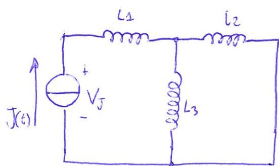
La rete ridotta per le tensioni impulsive è formata solo da induttori, generatori di corrente e da interruttori che aprono. Il generatore impulsivo di corrente funge da interruttore che apre. tutti gli altri bipoli vanno in corto circuito.
