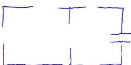
La rete ridotta per le correnti impulsive è formata solo da condensatori, generatori di tensione, e interruttori che chiudono.
