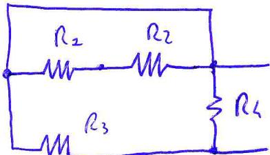
$$R_h = \frac{R_3 \cdot R_4}{R_3 + R_4} \Rightarrow 60 \cdot (R_3 + R_4) = R_3 \cdot R_4$$
