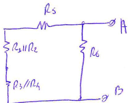
$$R_{eq\text{AB}} = R_6 // \left[ R_5 + (R_4//R_2) + (R_3//R_1) \right] = 7,5 \Omega$$
