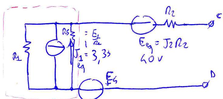
Se  $R_3$  si semplifica perché è in parallelo al generatore parallelo di tensione
