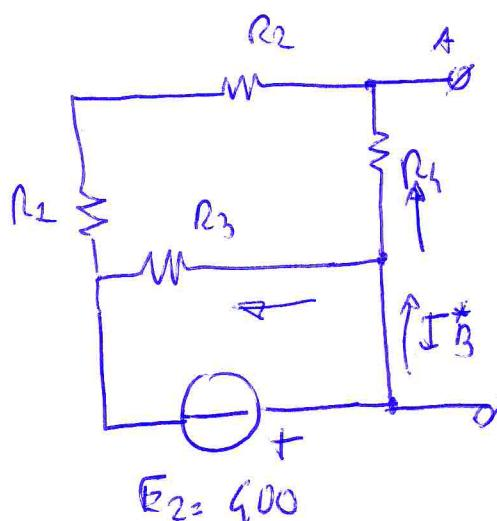
$$R_{eq}^* = R_3 // (R_2 + R_4 + R_L)$$
