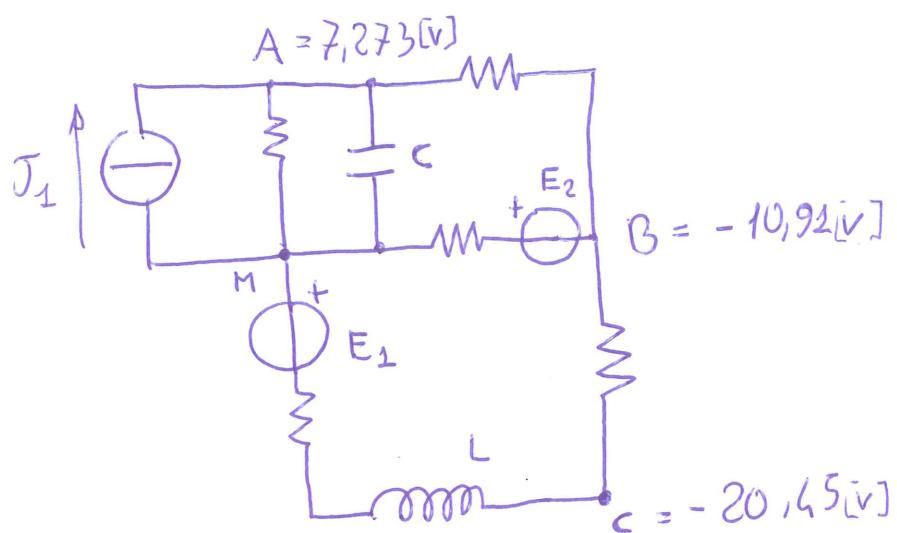
Si vede facilmente che la capacità  $C$  è posta in un punto equipotenziale al nodo A rispetto al nodo di massa M. Il calcolo dell'energia immagazzinata su questo bipolo è dunque
