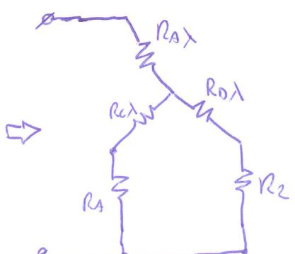
Quindi la Reg della rete è data dal circuito delle serie  $(R_{C\lambda} + R_1) // (R_{D\lambda} + R_2)$  il tutto sommato a  $R_{A\lambda}$ . (fare i calcoli sostituendo i valori)
