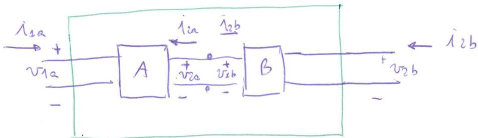
$$\begin{bmatrix} v_{21a} \\ -i_{21a} \end{bmatrix} = \begin{bmatrix} v_{2b} \\ i_{2b} \end{bmatrix}, \quad \begin{bmatrix} v_{22a} \\ -i_{22a} \end{bmatrix} = T_a^T \begin{bmatrix} v_{21a} \\ i_{11a} \end{bmatrix}, \quad \begin{bmatrix} v_{2b} \\ -i_{2b} \end{bmatrix} = T^T \begin{bmatrix} v_{2b} \\ i_{2b} \end{bmatrix}$$
