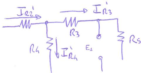
$$I_{R3}' = I_{R2}' = \frac{I_{R2}'}{R_4 + (R_3 + R_5)} \cdot R_4 = \frac{0,6 \cdot 10}{30} = 0,2 A$$
