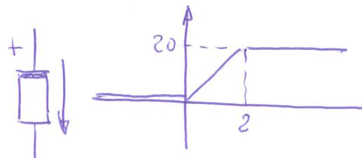
Si ricordi che se ho due bipoli in parallelo il punto di lavoro è dato dall'intersezione delle due caratteristiche esterne, ad esempio
