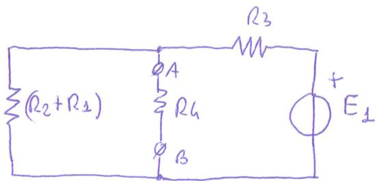
$R_S$  si trascura per definizione di parallelo di bipoli.
