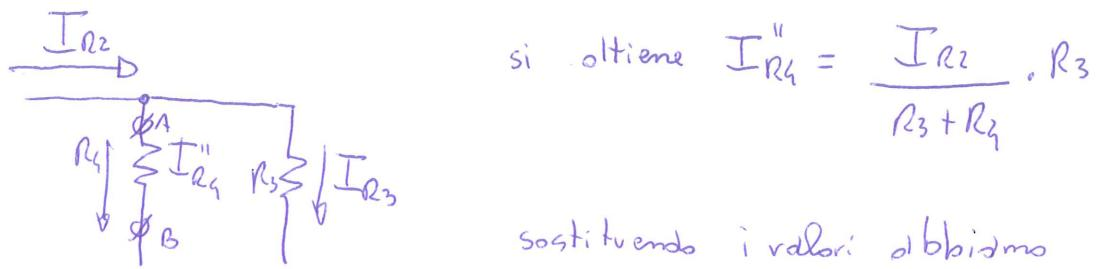
si ottiene  $I_{R4}'' = \frac{I_{R2}}{R_3 + R_4} \cdot R_3$
