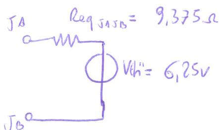
ora possiamo alla porta JA e JB la corrente impressa  $J_z$ , ovvero ricalchiamo ciò che costituisce il carico della rete equivalente di Thevenin
