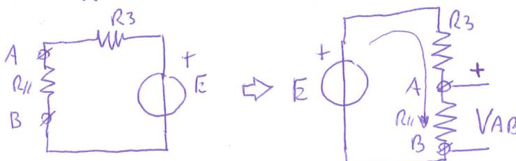
Posso affermare che  $V_{AB}$  è proprio  $V_{R_4}$  perché richiamo nuovamente la definizione di bipoli in parallelo.
