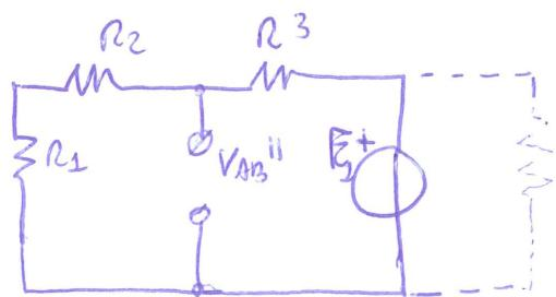
Per trovare  $V_{AB''}$  applico il partitore di tensione
