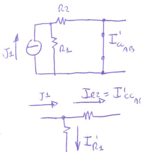
si noti che da parte di destra della rete risultà indipendente dato che si trova connessi in parallelo a un corto circuito.
