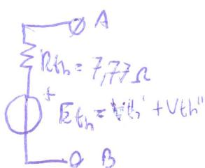
Quindi il generatore reale equivalente di Thévenin alla porta AB è dato da  $R_{th} = 7,77 \Omega$  e  $E_{th} = V_{th}' + V_{th}''$
