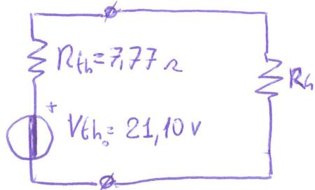
E applico il partitore di tensione per trovare la  $V_{RL}$ , la  $I_{RL}$ ,
