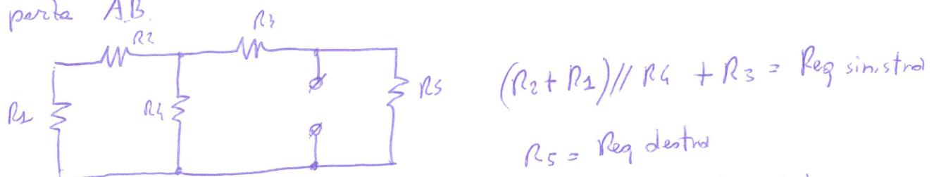
$$(R_2 + R_4) // R_3 + R_5 = \text{Reg sinistra}$$
