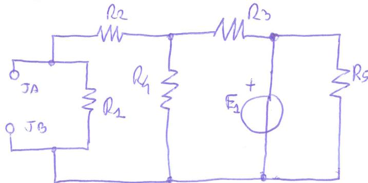
ri-calcoliamo la  $R_{eq}$  della rete passiva, si deve ricordare ogni volta che si cambia porta.
