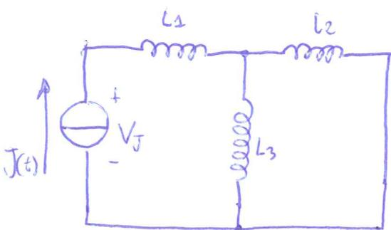
La rete ridotta per le tensioni impulsive è formata solo da induttanze, generatori di corrente e da interruttori che aprono. Il generatore impulsivo di corrente (unzel da interruttore che apre. tutti gli altri bipoli vanno in corto circuito.
