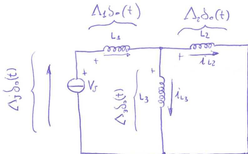
Equazione di compensazione delle tensioni impulsive
